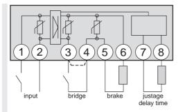
Fig.: Fast-acting rectifier
