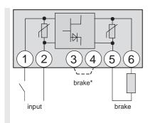
Fig.: Phase rectifier
