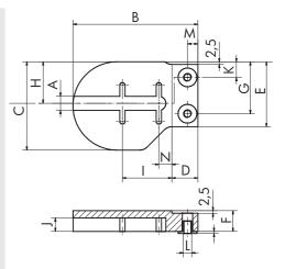
Fig.: Right bracket (C) PE
