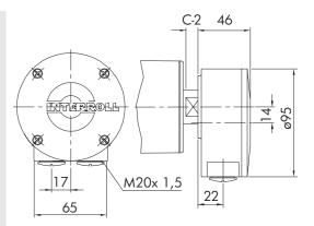
Fig.: Terminal box, aluminum
