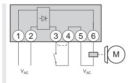
Fig.: Multiswitch rectifier
