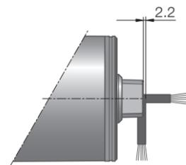
Fig.: Shaft cap, standard,
