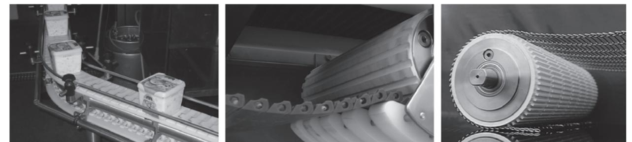
Modulare Kunststoffbänder, thermoplastische Bänder sowie Bänder aus Stahlgeflecht oder Draht werden formschlüssig, d. h. ohne Bandspannung, angetrieben. Da das Band kaum direkten Kontakt mit der Trommel hat, ist die Wärmeableitung in diesen Anwendungen weniger effektiv. Aus diesem Grund sollte der Trommelmotor mit einem Frequenzumrichter eingesetzt werden, der für diese Anwendung optimiert ist.
