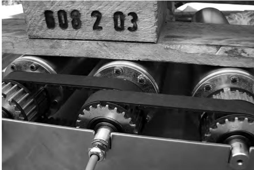
Bei Anwendungen ohne Förderband oder mit einem schmalen Band, das weniger als 70 % der Trommelmotorbreite bedeckt, kann die Wärme des Motors nicht mehr über das Band abgeleitet werden. Für solche Anwendungen empfehlen wir einen 2-poligen Asynchron-Trommelmotor oder Synchron-Trommelmotor mit einem Frequenzumrichter einzusetzen.
