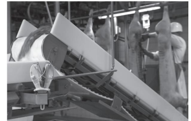
Interroll Trommelmotoren sind außerordentlich hygienisch und leicht zu reinigen. Alle Trommelmotoren für den Einsatz in der Lebensmittelindustrie entsprechen den Vorgaben der EG 1935-2004 und FDA. NSF-konforme Motoren sind auf Anfrage erhältlich. Interroll ist Mitglied der EHEDG (European Hygienic Engineering Design Group).
