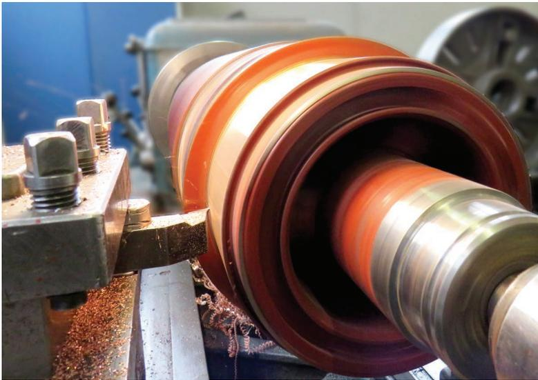
Überdrehen eines Kollektors (GS-Anker)
