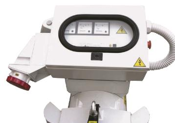
*Zapfwellengenerator AC, E-Schaltkasten*
